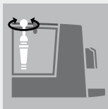
Filter in Wassertank eindrehen
