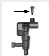
Aufschäumer mit herausgenommenem Luftansaugstutzen
